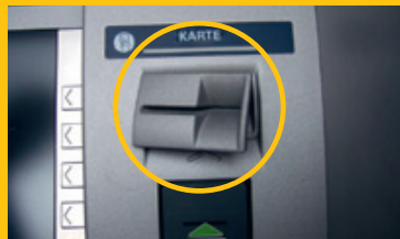
Aufsatz-Attrappe am Karteneinschub (Beispiel) Kopiert Daten des Magnetstreifens.
