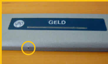
Minikamera (Beispiel) Filmt ungeschützte Eingabe des PIN-Codes.
